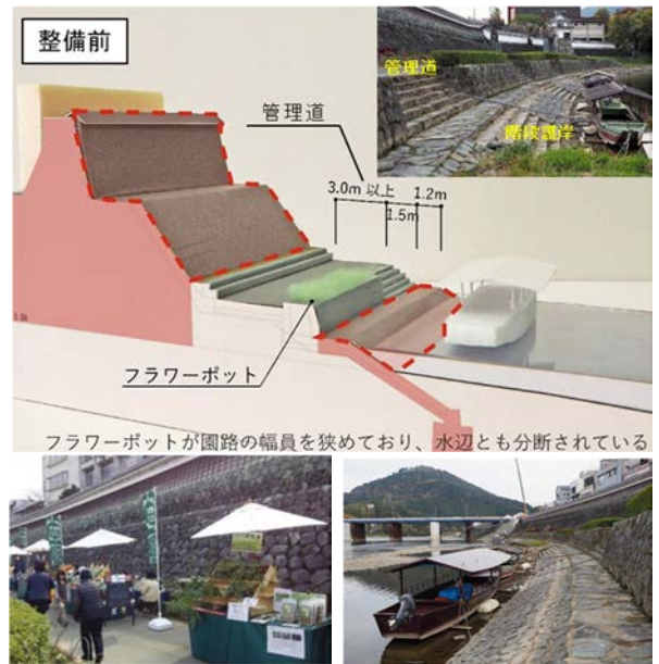
図-2 肱南地区の整備前状況
