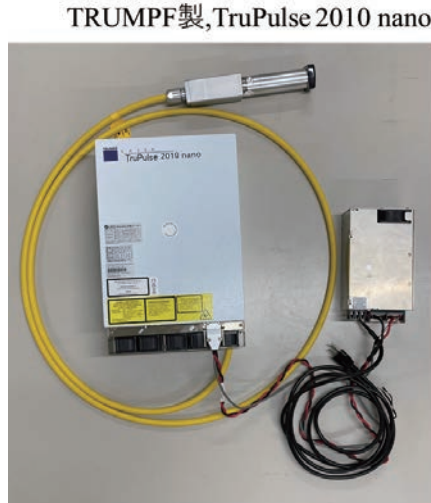
図- 3 ファイバーレーザー光源
