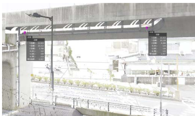
図-3 導水型排水管の3次元モデル
