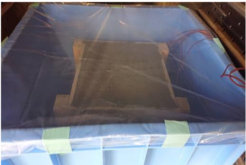
図 3 養生方法 (養生シート無し)
