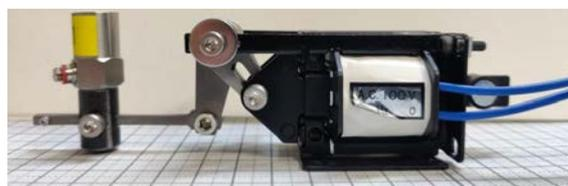
図-1 作製した打撃装置（側面図）
