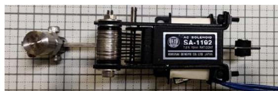
図-2 作製した打撃装置（上面図）
