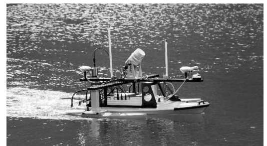
図.1 リモコンボート搭載マルチビーム測深機
