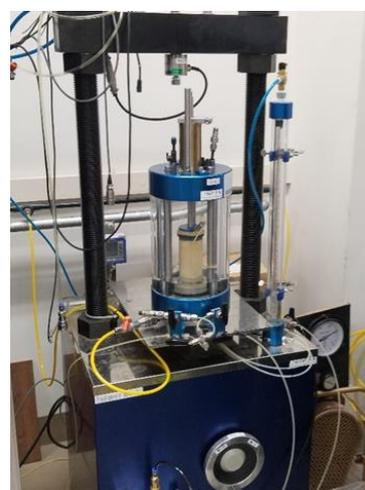
図2 香川高専の三軸圧縮試験機
