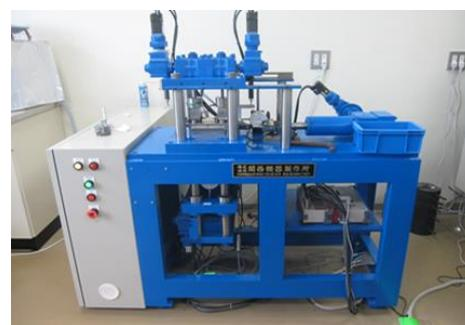
図1 高知高専型一面せん断試験機
