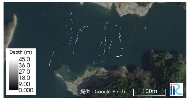
図-3 Deeper を用いて計測した湖底までの水深
