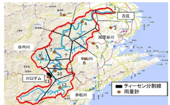
図 2 使用した雨量計とティーセン分割図
