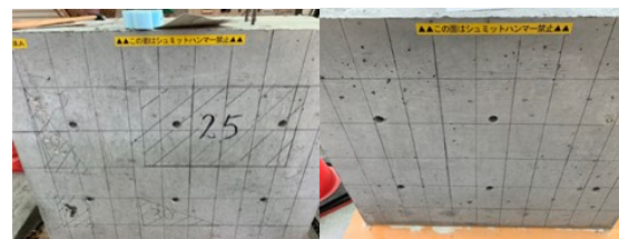
図 4 改善後の打音供試体
