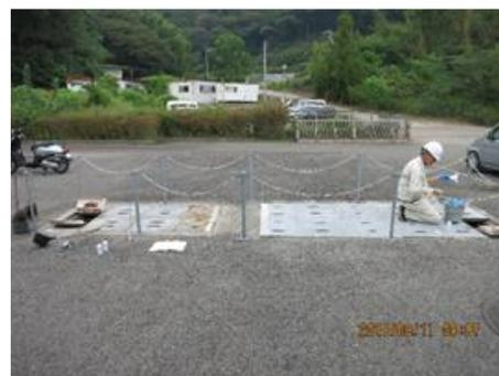
図 1 高知自動車道南国 SA 上り線のグリストラップでの調査の様子
