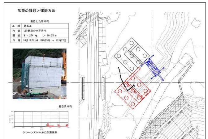
図-3 クレーンによる場内小運搬の解析例
