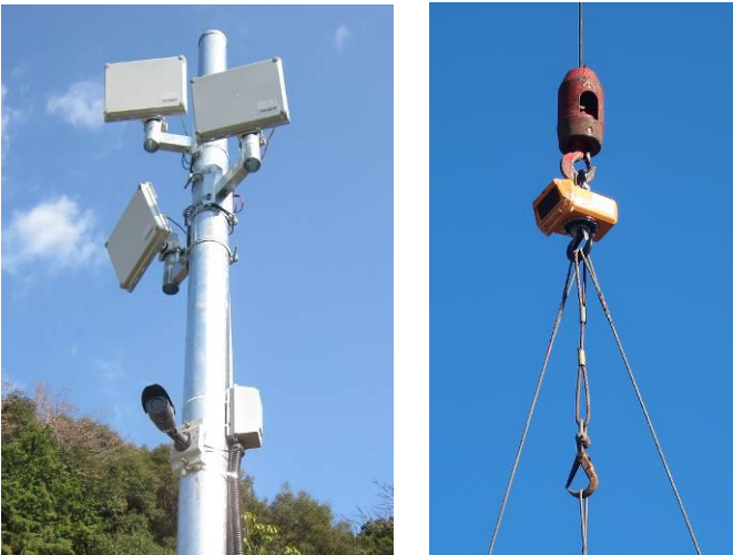
写真-2 ロケーターとカメラ(左)、クレーンスケール(右)
