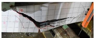
図 3 せん断破壊型供試体の破壊例
