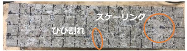
写真-1 AE-1試験体 (300サイクル時)
