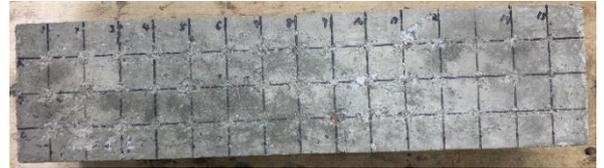
写真-2 nonAE-1試験体 (110サイクル時)
