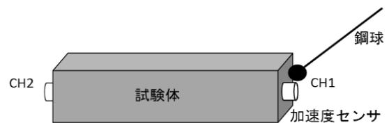
図-1 透過法による弾性波速度の測定
