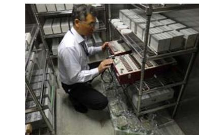
写真-2 膨張ひずみの測定状況
