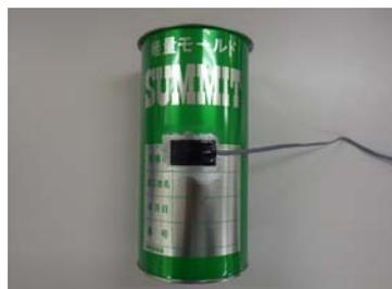
写真-1 円筒型枠及びひずみゲージ
