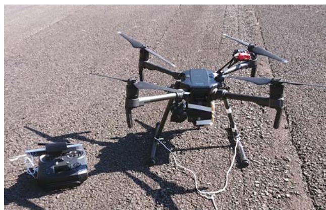
図-2 スマートフォンを UAV 本体に設置した状況
