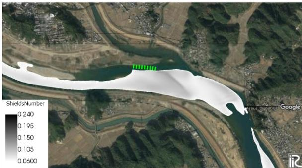
図-5 水制群の設置による河道改修法 (Case3) 流量 3500m<sup>3</sup>/s 時の無次元掃流力コンター (無次元掃流力が 0.06 を超えると河床砂が移動する)
