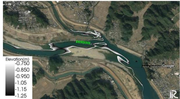
図-6 水制群の設置による河道改修法 (Case3) 洪水後のスジアオノリの生育に適した河床高の範囲
