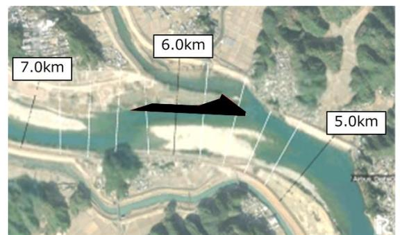
図-1 導流堤の改修による河道改修法 (Case1)
