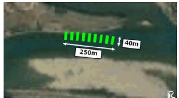
図-2 水制群の設置による河道改修法 (Case3)
