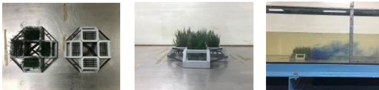
図5 水理実験模型および染料投入による流れの可視化
