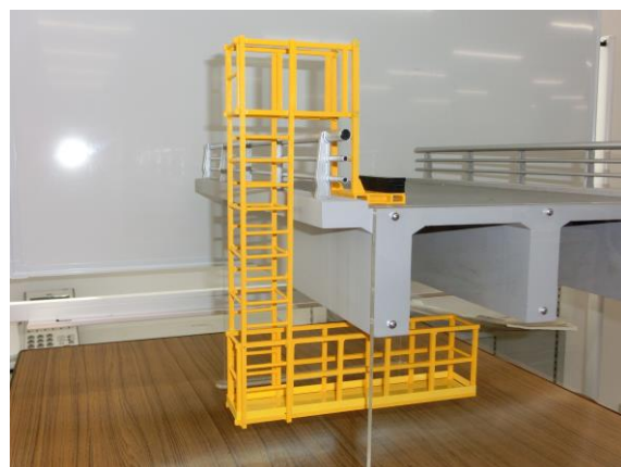
写真 1 移動式足場 1/15 縮尺模型
