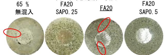
図-5 拘束ひび割れ確認試験
