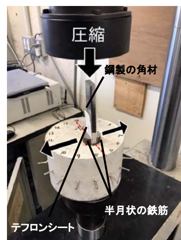
図 3 ひび割れ導入状況
