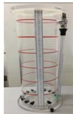
写真-1 改良型透水試験装置
