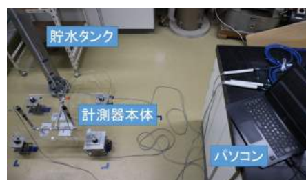
写真 1 沈下量計測器 完成図
