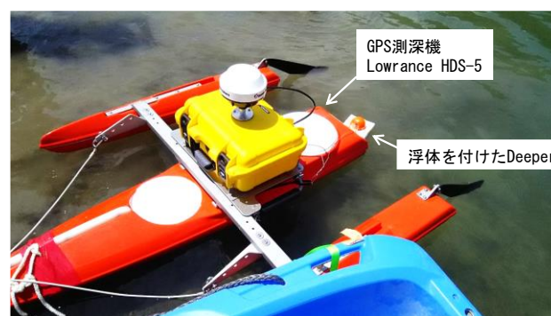
図-2 GPS 測深機と Deeper による計測状況
