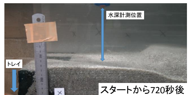
図-3 通水中の河床形状の様子
