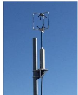
図2 三次元超音波風速計
