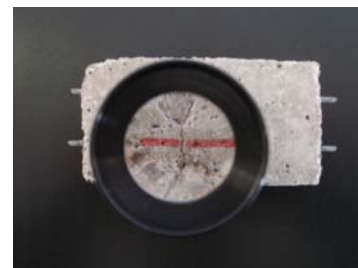
写真－7 ひび割れ充填性の観察方法
