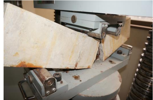
図5 鉄筋の破断で破壊した試験体
