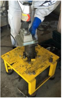
写真-1 締固め時のバイブレーター
