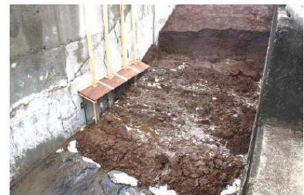
図6 大型模型実験の法面崩壊 (国総研河川研究室 HP, 20時間後)
