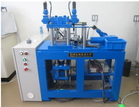
図1 高知高専型一面せん断試験機
