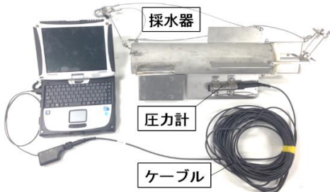
図-2 採水器と ケーブルで繋いだ圧力計
