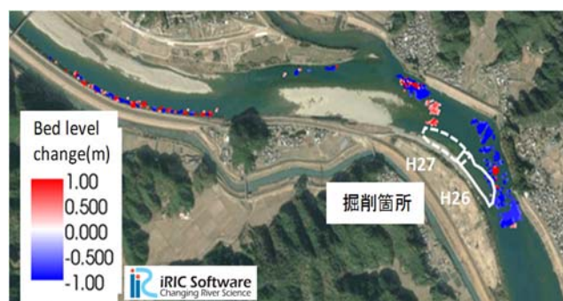
図-5 実測から得られた出水前後の河床変動量
