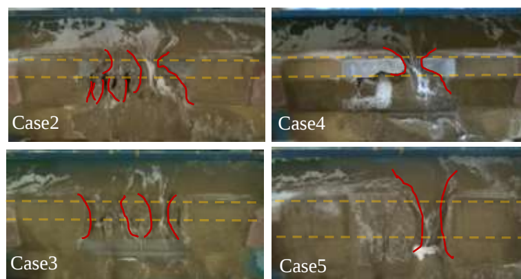
図 7 補強の違いによる決壊後の形状
