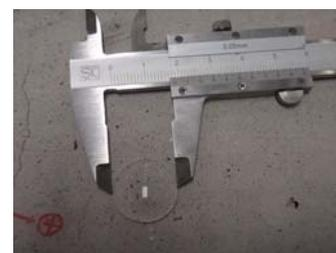
写真-2 水滴径測定状況
