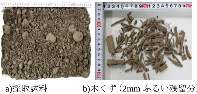
図-1 津波堆積物分別土の例
