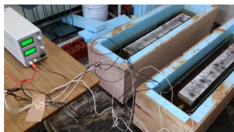
図 3.2 電食試験状況
