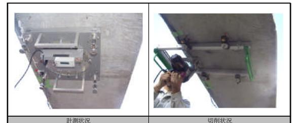
写真-4 スリット応力解放法による調査状況
