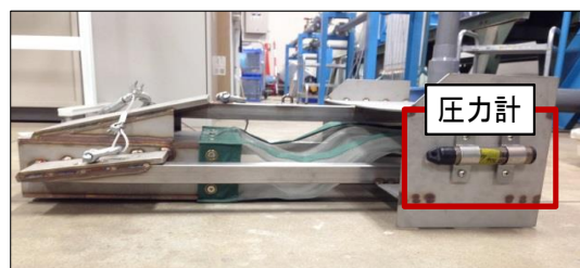
写真-1 採砂器の改良点
