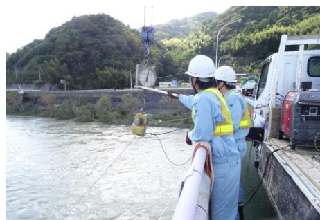
写真-2 採砂器のワイヤーに設置したテンションメーター
