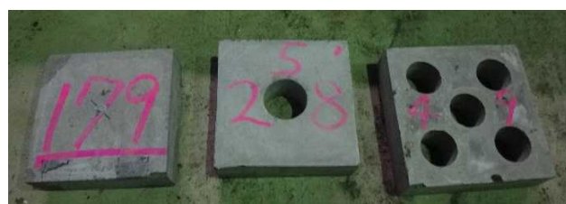
写真 2 被覆ブロック模型（左から空隙率 0, 8, 24%）
