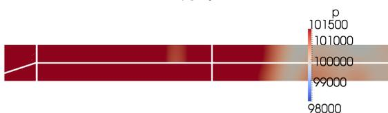
図-8 圧縮時のシャッター開放 0.05s 後の圧力分布
