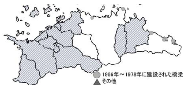
図-5 塩害による損傷橋梁の分布(建設年別)
