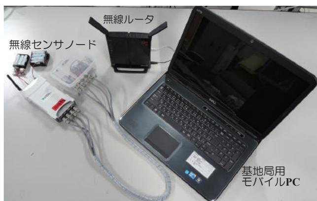
図-1 無線加速度センサシステムの構成
