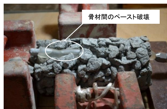
写真1 ポーラスコンクリートの剥脱状態
