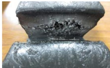
写真 - 2 せん断試験後の供試体断面
