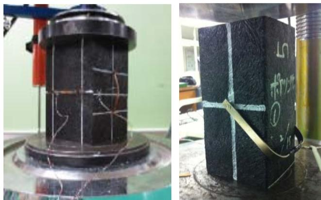
a) 鉛直・水平方向 : I 型 LDT      b) 鉛直 : I 型、水平 : U 型
