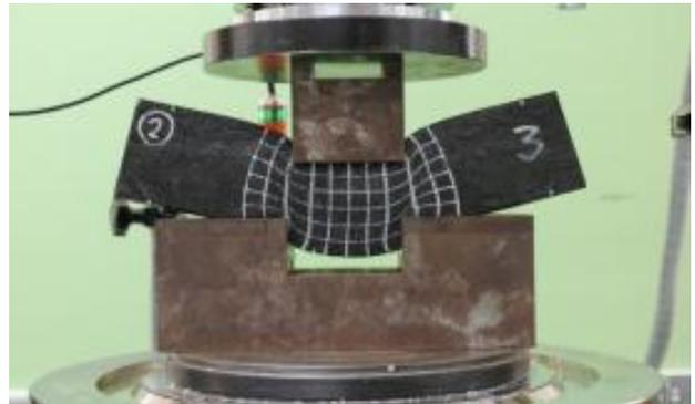
写真 - 1 せん断試験の状況 (30mm 変位時)
