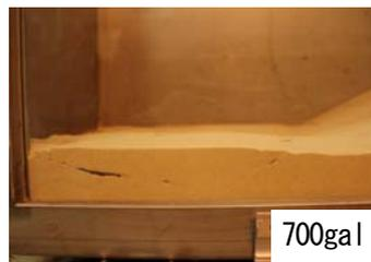
図-9 法面全体滑りの底面部の滑り面
