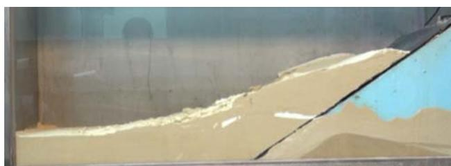
図-6 法面部分滑りによる崩壊 (970gal)
