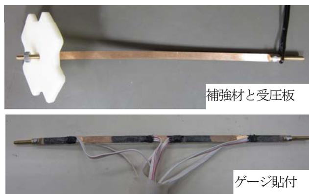
写真-1 補強材と受圧板
