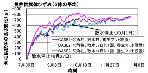
図-3 散水が収縮に与える影響(屋外曝露試験)
