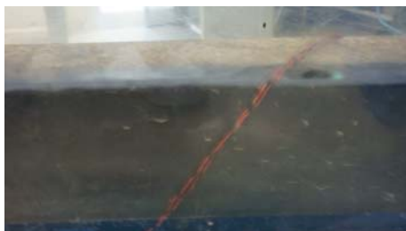
(a) UTP センサー (埋設管巻き付け)
