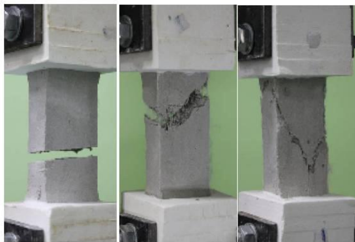
写真-1 供試体の破壊状況
